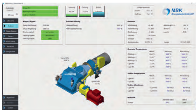
Visualisierung der Kraftwerkssteuerung von der steirischen MBK Energietechnik GmbH, die für die Automatisierung der Anlage sorgte.
