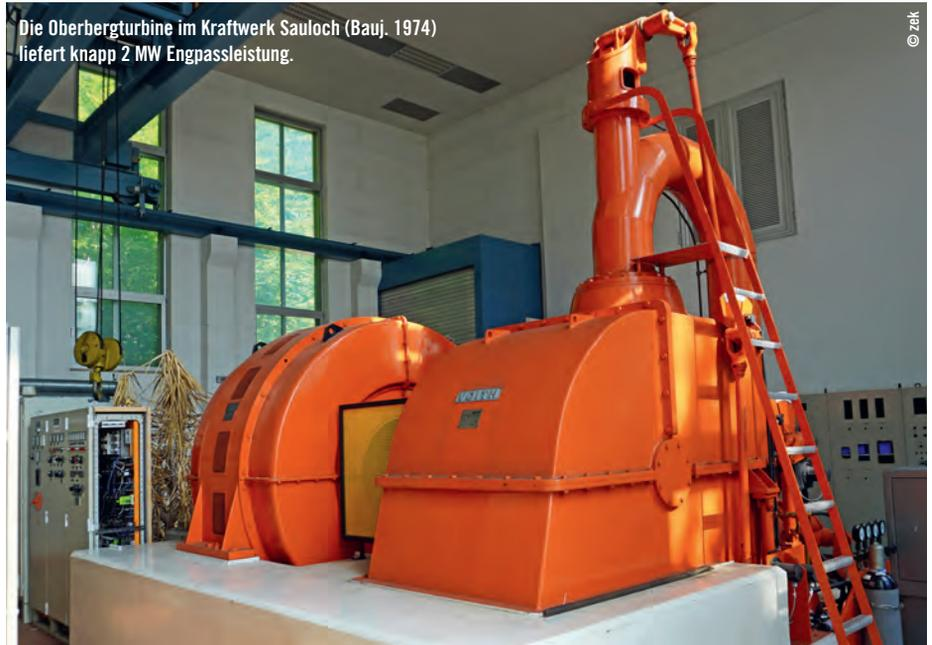
Die Oberbergturbine im Kraftwerk Sauloch (Bauj. 1974) liefert knapp 2 MW Engpassleistung.
