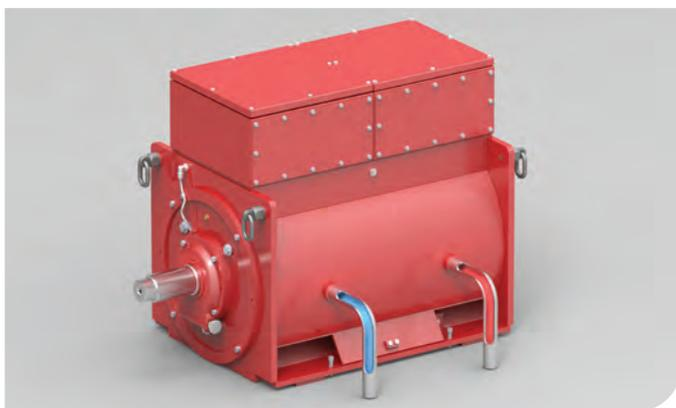
**Wassermantelkühlung.** Wenn in einem Wasserkraftprojekt der Fokus auf Design und einem geringen Geräuschpegel liegt, dann ist eine AEM-Maschine mit Wassermantelkühlung die perfekte Wahl. Im Gegensatz zu Maschinen mit Aufsatzkühlern, wird bei wassermantelgekühlten Maschinen das Kühlwasser direkt durch den Gehäusmantel geleitet. Das Wasser umströmt geführt den Rücken des Ständerblechpaketes und führt somit dessen Wärme ab.
