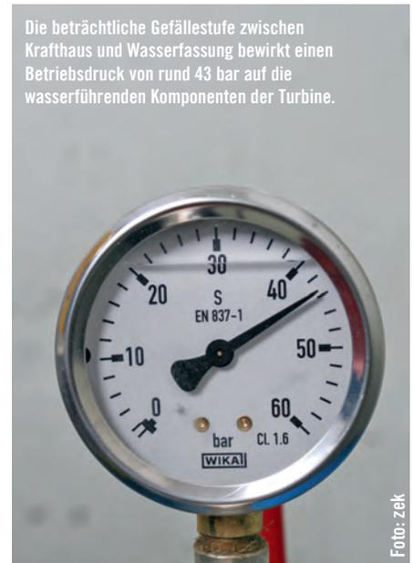
Die beträchtliche Gefällestufe zwischen Krafthaus und Wasserfassung bewirkt einen Betriebsdruck von rund 43 bar auf die wasserführenden Komponenten der Turbine.
