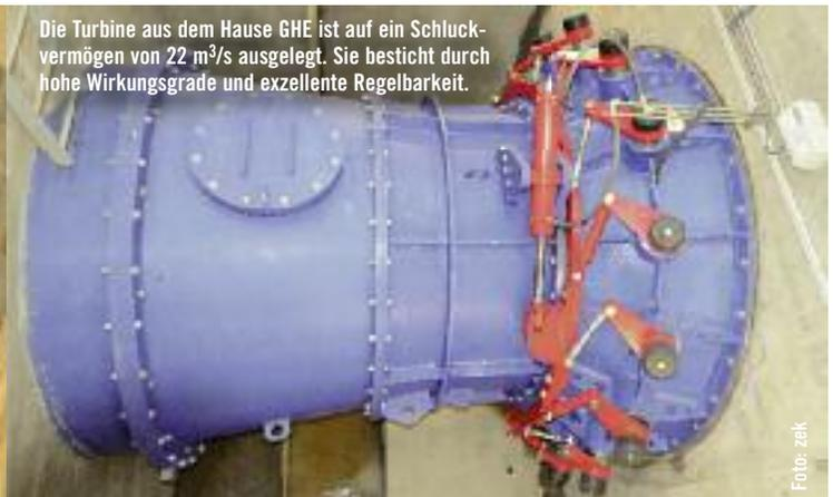
Die Turbine aus dem Hause GHE ist auf ein Schluckvermögen von 22 m<sup>3</sup>/s ausgelegt. Sie besticht durch hohe Wirkungsgrade und exzellente Regelbarkeit.
