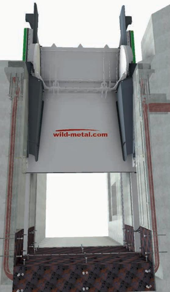
**Wir entwickeln, planen und konstruieren kombinierte Schützen mit aufgesetzter Stauklappe für Ihre spezielle Anlagensituation.**
